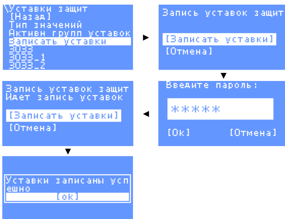
Рисунок 32 – Последовательность действий при сохранении уставок защит
