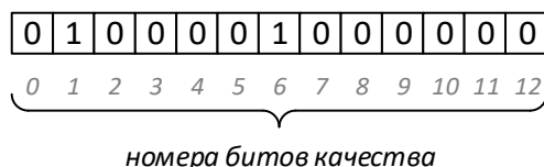
Рисунок 35 – Формат битов качества сигнала
